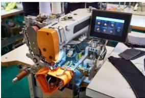
Máquinas de coser automáticas. Mediante el uso de procesos de programación, los sistemas automatizados industriales liberan a las personas de realizar trabajos repetitivos, optimizando el proceso y salvaguardando la salud de quienes trabajan operando estas máquinas.
