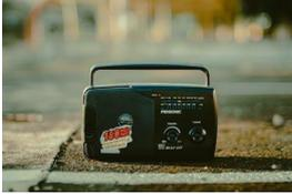
Radios antiguas. Estos dispositivos no procesan información a pesar de que cuentan con sistemas electrónicos. Funcionan recibiendo una señal electromagnética y convirtiéndola en un sonido audible. Este tipo de tecnología electrónica que no procesa información digital recibe el nombre de tecnología analógica.
